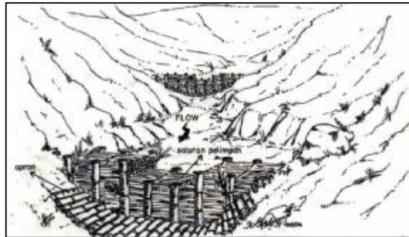
Gambar 12. Dam Penahan dengan konstruksi anyaman ranting, kayu/bambu
