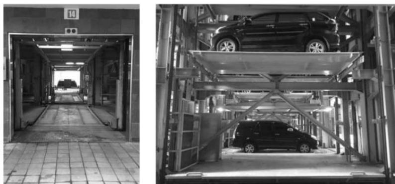
Gambar 3.95. Contoh penerapan sistem parkir mobil otomatis
