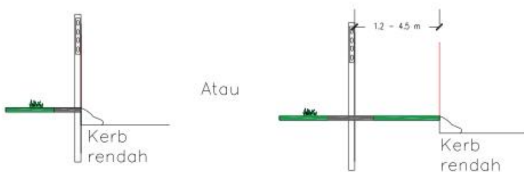
Gambar 26. Pagar Pengaman fleksibel Pada Jalan Berkecepatan Tinggi
