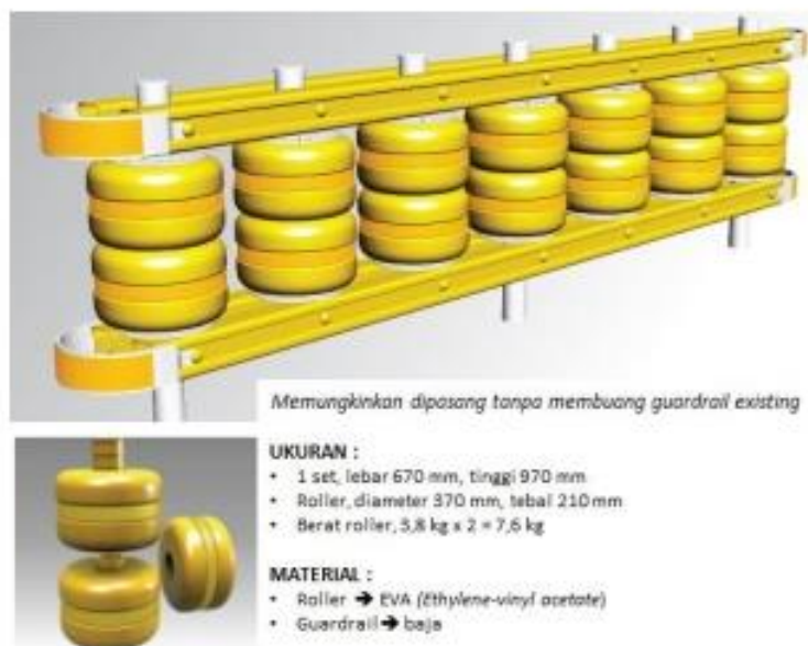
Gambar 30. Ukuran dan Material Safety Roller
