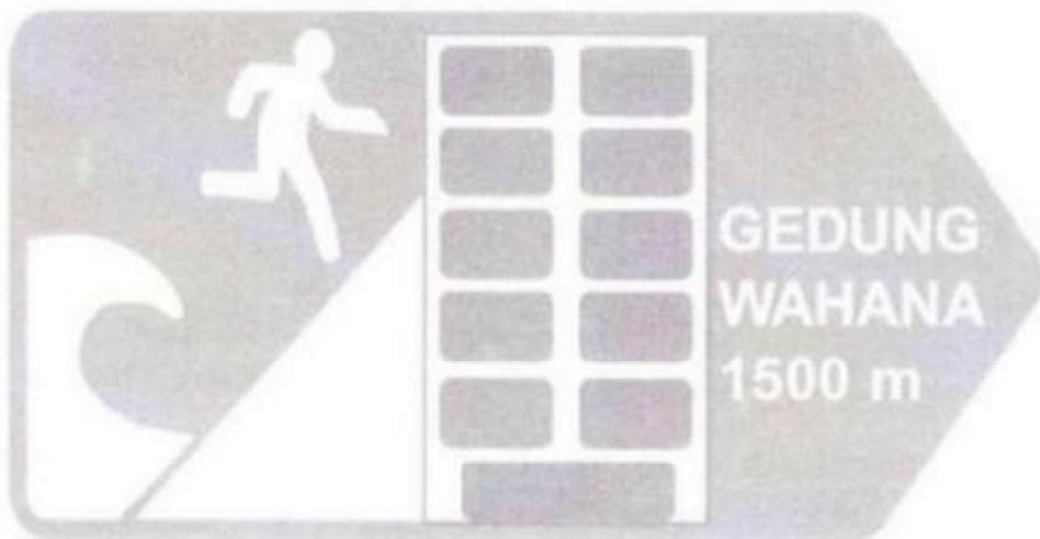
Gambar 25. Contoh rambu evakuasi lengkap dengan simbol, nama gedung dan jarak menuju ke tempat kumpul berupa bangunan
